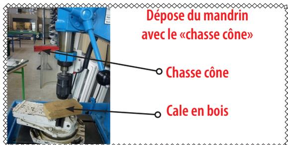
Dépose du mandrin avec le «chasse cône»
