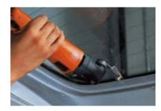
Cette lame spéciale dotée d'une butée réglable permet de séparer de l'intérieur les pare-brise, lunettes arrière et vitres latérales en un temps record et sans détériorations.
