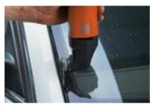
Pour des raisons esthétiques, le joint entre la carrosserie et la vitre est conçu pour être le plus étroit possible. La solution est alors d'utiliser la lame en forme de L en l'introduisant par le toit ou la colonne A.
