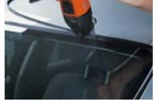
Les cadres de vitre vulcanisés (même ceux renforcés en aluminium) ne posent aucun problème à la longue lame en forme de L. En une seule opération, vous pouvez à la fois séparer la colle en polyuréthane et le cadre.
