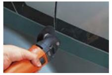
Grâce à la lame de scie HSS, vous couperez en un rien de temps la tôle de carrosserie jusqu'à 1 mm d'épaisseur ainsi que les éléments en plastique et en plastique renforcé de fibres de verre. Vous pourrez également séparer aisément et sans étincelles les éléments portants à double couche. Les lignes de coupe sont droites et ont une épaisseur de seulement 0,5 mm. L'avantage en plus: vous pouvez faire pénétrer la lame à n'importe quel endroit du matériau à couper.
