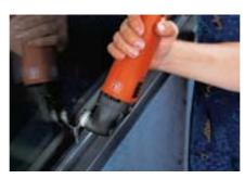
Pour les découpes de l'intérieur, en particulier pour les vitres latérales, vous disposez de lames à la géométrie spécialement conçue et à rendement de coupe élevé.
