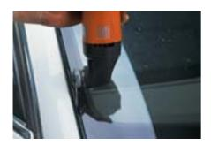
La lame en forme de L sert à couper et cisailler de l'extérieur la colonne A et le toit. Cette forme courte évite de devoir démonter sur de nombreux véhicules le revêtement intérieur de la colonne A.
