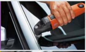
Le set Pro « Pare-brise voiture », avec ses couteaux, est spécialement conçu pour déposer rapidement et en toute sécurité les pare-brise de la plupart des voitures particulières.
