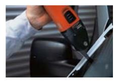
La longue lame en forme de L est spécialement conçue pour les camionnettes et les véhicules utilitaires légers.
