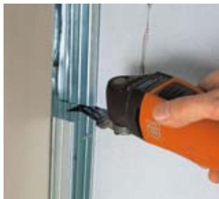
Lames de scie universelles E-CUT pour toutes les coupes et les travaux d'encastrement. Grâce à la denture bimétal, elles sont parfaitement adaptées au bois, au plastique, au placoplâtre, au crépi, aux profilés d'aluminium et même à la tôle.
