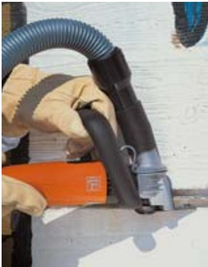
La lame droite à usage multiple permet de découper confortablement tous les matériaux étanches élastiques.
