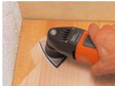
Poncer dans les angles et sur les bords. L'adaptateur faisant partie de la livraison transforme en un rien de temps FEIN SUPERCUT SECOND-OEUVRE en une ponceuse triangulaire performante.
