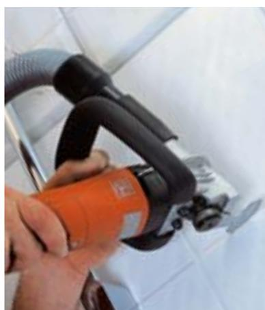
Le dispositif d'aspiration et les outils diamantés permettent d'enlever les joints de carrelage de manière rentable, précise et avant tout sans grande formation de poussière.
