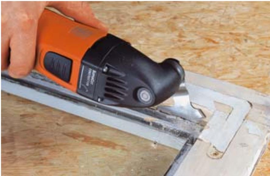
La lame forme segment vous permet de découper sur place les vitres isolantes posées dans le mastic sans devoir les briser. Cela signifie : pas de danger de blessure, aucuns travaux de rangement fastidieux et jusqu'à 80% de gain de temps.
