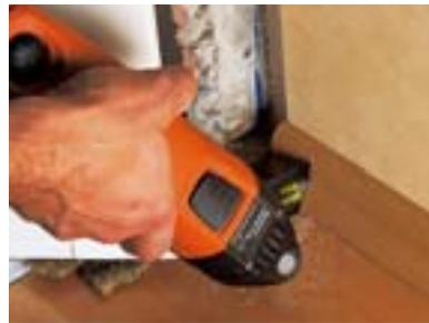
Vous pouvez réaliser rapidement et facilement des encoches dans des plinthes déjà montées.
