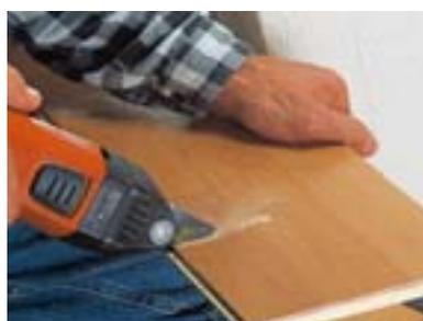
Il est possible à tout moment de réaliser des coupes exactes à la main. Les lames de scie de précision E-CUT permettent un profil de coupe propre – idéal pour l'ajustage et l'encastrement.
