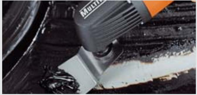
La spatule rigide peut être utilisée pour enlever l'enduit de protection des bas de caisse, les restes de colle de moquette et de carrelage, la rouille et les revêtements abîmés, etc.
