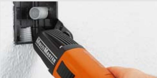
Avec les lames de scie E-Cut, vous réalisez rapidement à bout des évidements, découpes et ajustements de parquets, stratifiés, châssis de portes montés et plinthes.
