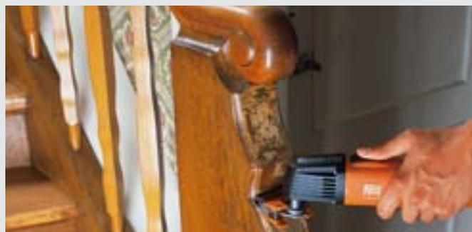
Grâce aux six profils interchangeables, vous serez en mesure de poncer tous les emplacements exigus et difficiles d'accès, les joints à rainure et languettes – dans le plus grand confort, et ce, avec un rendement de ponçage trois fois supérieur. Les profils creux et flexibles s'adaptent parfaitement aux situations les plus variées.
