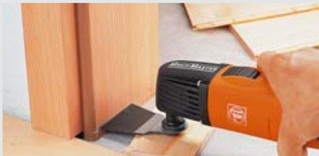
La lame de scie E-Cut vous permet de vous mesurer aux évidements, découpures et ajustements de parquets, stratifiés, châssis de portes montés et plinthes. Le moyeu déporté des lames de scie E-Cut vous permet de travailler à plat sur les surfaces. La denture adaptée autorise un travail rapide et soigné.
