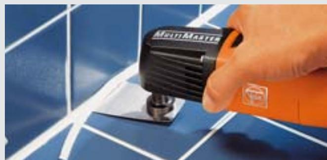
Avec la spatule flexible, vous éliminerez les matériaux de joint élastiques, les couches de peinture couleur, les restes de colle, les autocollants dans la maison et dans les installations sanitaires. Livrée par pack de 2.
