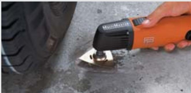
Vous pouvez éliminer les taches d'huile sur les sols en béton ou sols de garage, les graffiti sur les façades en béton ou en pierre ou d'autres résidus encore à l'aide de la râpe à concrétion carbure.
