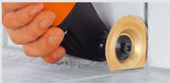
La lame de scie segment à concrétion carbure est l'alternative économique à la lame diamantée.
