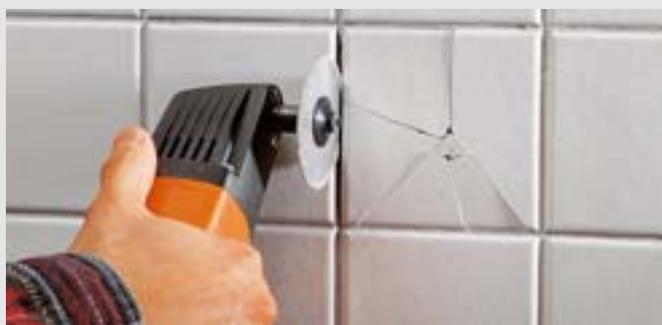
La lame de scie diamantée vous permet de découper les joints en marbre ou en stuc et de réaliser des fentes dans le crépi, la brique, la pierre ponce, l'aggloméré perforé en nid d'abeilles et le béton cellulaire.
