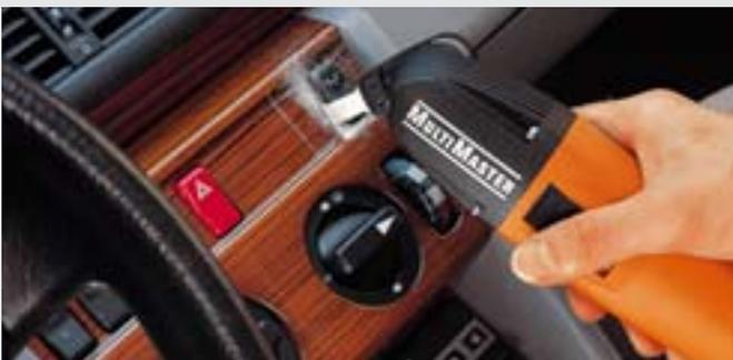
Pour les travaux de sciage dans les endroits difficiles d'accès ou pour les petits évidements. Découpures possibles dès 10 mm de largeur. Convient parfaitement aux travaux d'affûtage et de limage en liaison avec la lime diamant et la plaquette de fixation 15°. Bref, l'idéal pour toutes les installations et les montages ultérieurs.
