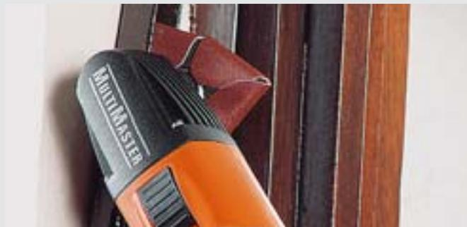
Le papier en feuille de trèfle permet d'atteindre les creux, fentes et gorges. L'abrasif est placé autour d'un patin de ponçage spécial permettant de poncer de trois côtés.
