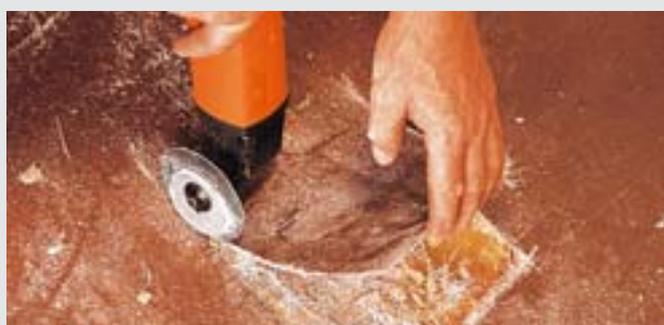
Les lames de scie HSS vous permettront de scier les plastiques renforcés de fibres de verre ou de carbone et tôles jusqu'à 1 mm. Les lames de scie à moyeu déporté permettent de travailler à plat sur une surface. La segmentation permet des coupes en angle droit sans reprise.
