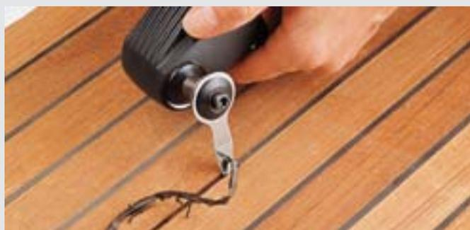
Cette lame permet tout autant de détacher facilement et sans efforts les joints transversaux des ponts de bateaux que de procéder aux réparations à des endroits délicats comme les structures de cabine, les bollards, les plats-bords, les taquets et les courbes.
