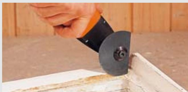
Les lames de scie vous permettent de démastiquer les vitrages simples et composites sans risque de bris de verre, ni travaux préliminaires fastidieux.
