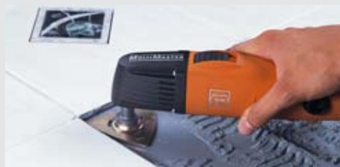
Grâce à la râpe HM, vous obtiendrez des résultats parfaits lors de la rectification plane des colles de carrelage, du meulage des bords du carrelage, du ponçage grossier du bois, du mastic, de la peinture, etc.
