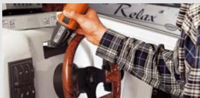
Pour les travaux de sciage dans les endroits difficiles d'accès ou pour les petits évidements. Découpures possibles dès 10 mm de largeur. Convient parfaitement aux travaux d'affûtage en liaison avec la lime diamant et la plaquette de fixation 15°.
