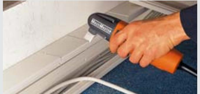
Sciage du bois, du mastic et des matériaux souples. Lames de scie HSS pour plastiques renforcés de fibres de verre ou de carbone et tôles jusqu'à 1 mm. Les lames de scie à moyeu déporté permettent de travailler à plat sur une surface. La segmentation permet des coupes en angle droit sans reprise.
