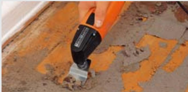
La spatule rigide vous permet d'enlever les restes de colle de moquettes et carrelages, des calamites, de la protection de bas de caisse et des revêtements endommagés.
