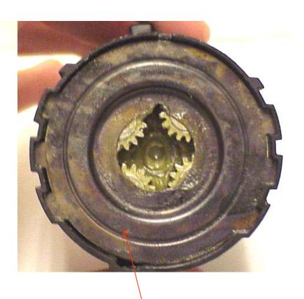
TRANSMISSION PLATE SHOULD BE DEPRESSED INTO GEARBOX
